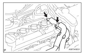
(d) Disconnect the ventilation hose and ventilation hose No. 2.
