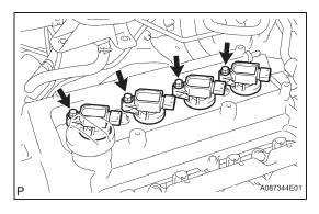
(d) Install the ignition coil with the bolt.
