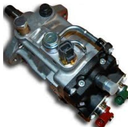
**2°/** On peut contrôler la résistance des 2 électrovannes qui se trouvent derrière la pompe haute pression DENSO HP2. Ces 2 électrovannes se différencient par leurs couleurs :
